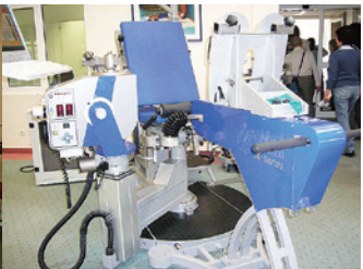
ある動きをしたときに、どの筋肉がどのくらい力を発揮しているかを測ることができる機械。その数値を目安にしてトレーニングが行われる。スポーツ医学でも有名なこのクリニックには、F1レーサーのミハエル・シューマッハーをはじめ、オリンピックのメダリストやサッカー選手が医師の処方せんに従ってトレーニングしたり検査を受けたりするために訪れている
